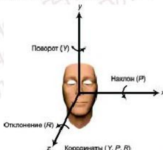
Рисунок 4 — Определение угловых координат относительно фронтального положения
